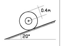
Puesto que el cuerpo rueda sin deslizar, la relación cinemática entre la aceleración angular y la aceleración del centro de masa es
