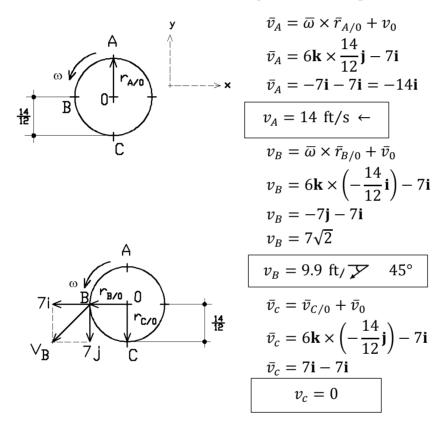
Que la velocidad de *C* sea nula, se puede deducir fácilmente de hecho de que ese punto está en contacto con otro del suelo, y ambos deben tener la misma rapidez, ya que no se desliza la llanta sobre el suelo.
