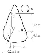
5. Calcule la velocidad lineal del vértice *C* de la placa triangular de mecanismo que se muestra en la figura, sabiendo que la rapidez angular de la barra *OB* es de 5 rad/s en el sentido indicado
