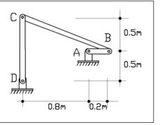
Las barras AB y CD rotan alrededor de puntos fijos. La barra  $\underline{BC}$  está dotada de movimiento plano general. Para determinar su rapidez angular, emplearemos el método del centro instantáneo de rotación, que en este problema se puede hallar muy fácilmente, pues está en la intersección de la barra CD con la prolongación de la AB.
