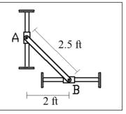
Debemos comenzar estableciendo una relación cinemática entre la aceleración angular de la barra y la aceleración lineal de su centro de masa; primero es necesario relacionar la aceleración angular con la lineal de cualquier punto de la barra.
