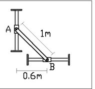
Trazamos perpendiculares a las velocidades de *A* y *B*, y en la intersección está el centro instantáneo de rotación. Como la distancia del centro al extremo *A* es de 0.6 m, la velocidad angular de la escalera es
